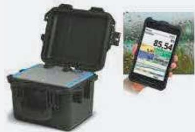
El **Transmisor NivuFlow Mobile 600 (NFM600)** utiliza la tecnología de tiempo de tránsito, conserva el concepto de un medidor robusto y portátil diseñado especialmente para mediciones temporales, sin la necesidad de energía externa. Al igual que el NF600, el NFM600 es apto para mediciones de caudal en tuberías llenas mediante sensores de inserción o tipo *clamp-on*.
