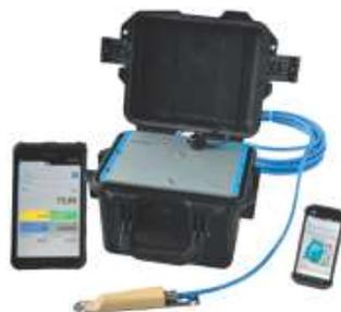
El Transmisor **NivuFlow Mobile 750 (NFM750)**, es el equipo portátil de medición mediante tecnología de correlación cruzada. Este equipo es el sucesor de la familia de productos PCM.
