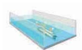
Montaje sensor tipo cuña
