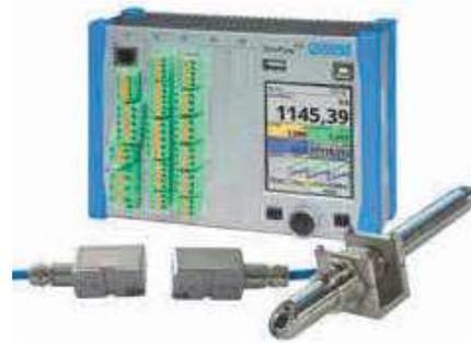
El **Transmisor NivuFlow 600 (NF600)** ha sido diseñado especialmente para **mediciones de caudal en tuberías llenas**. Se pueden configurar hasta 4 rutas de medición (ampliable hasta 32 rutas), logrando una gran precisión en la medición. La instalación se puede realizar sin detener el proceso mediante sensores del tipo *Clamp-On* o inserción. El sistema se adecúa para la medición de caudal en medios limpios y levemente contaminados.
